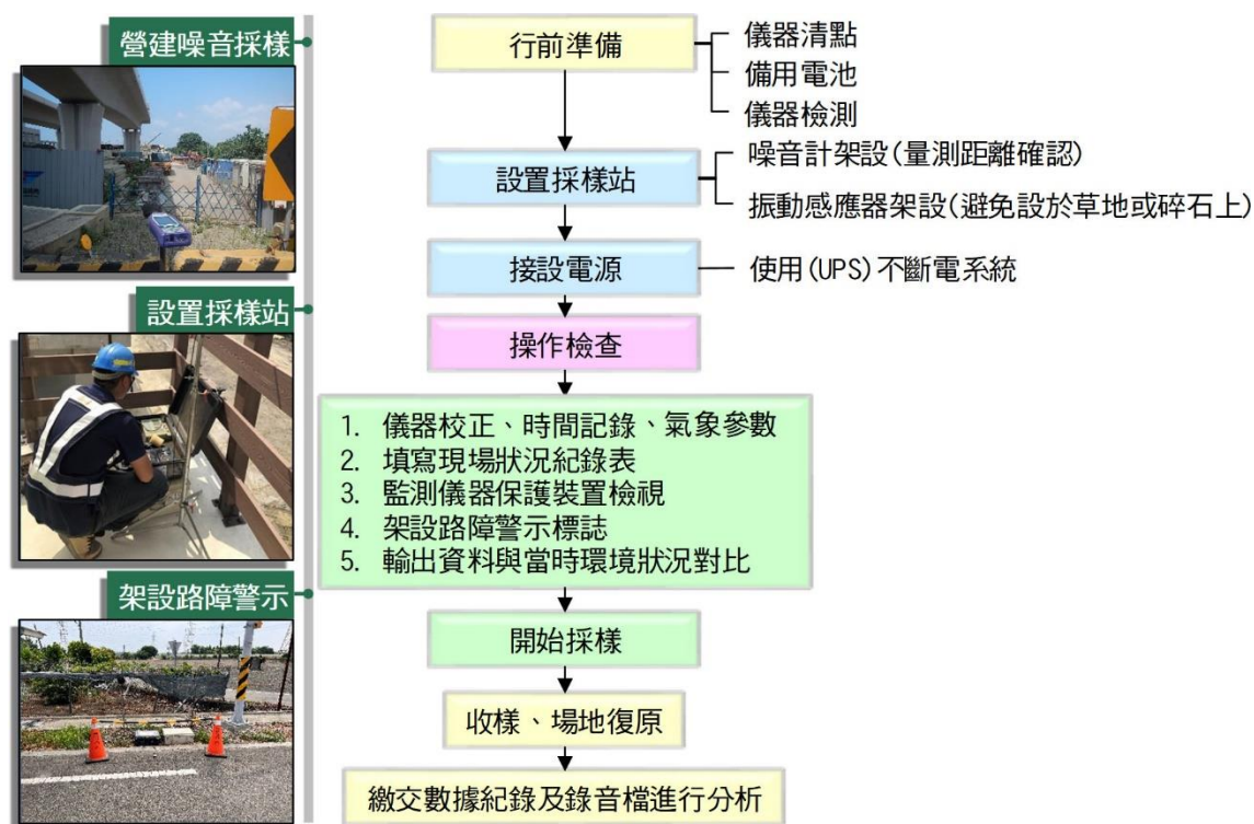
圖 2 噪音振動監測作業流程
